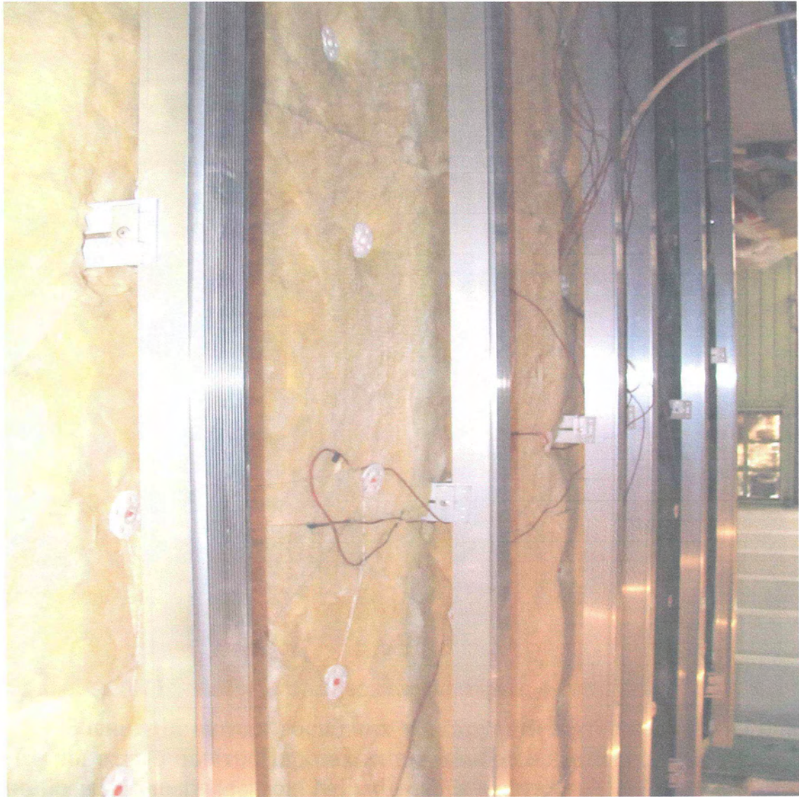
Рис.1.3 – Зовнішній вигляд дослідних зразків з утеплювачем із плит із скляної вати та мінеральної вати
