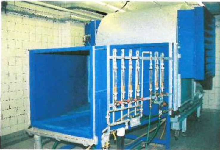
Рис. 1: Испытательный стенд по имитации сильных дождевых осадков Берлинского технологического института. Общий вид инженерной конструкции
