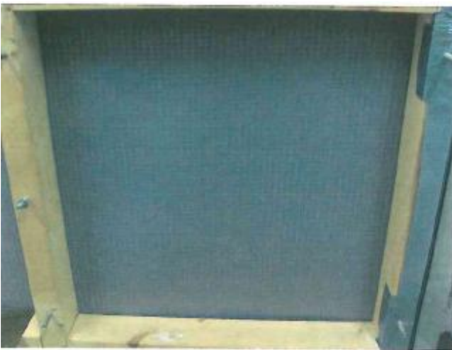
Рис. 8: Вид сзади – увеличенное изображение. Отсутствие следов стекания воды на обрешетке
